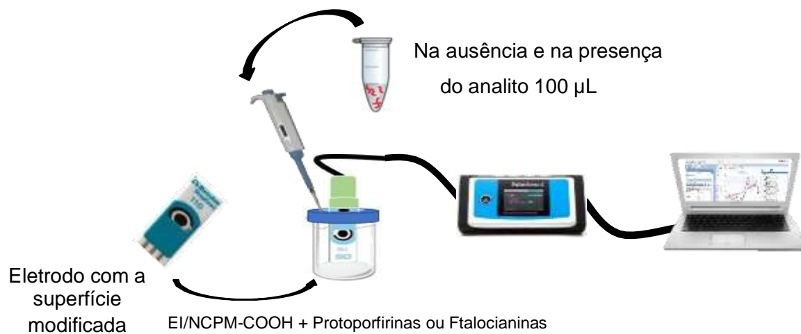
Figura 29- Esquema de imobilização de APT na superfície de SPE/MWCNT-COOH.
