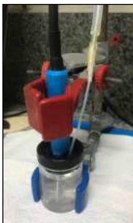
Figura 16 – Fotografia333 do sistema eletroquímica em funcionamento.
