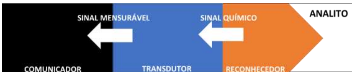
Figura 3 - Modelo esquemático dos principais componentes de um sensor químico.
