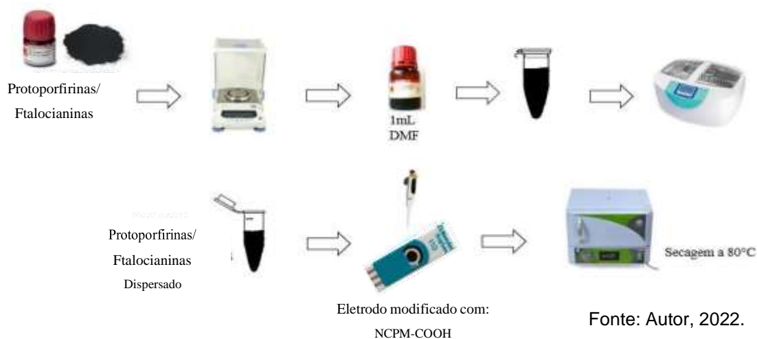
Figura 28 - Esquema do preparo das dispersões e modificação dos eletrodos impressos com nanomateriais carbonáceos.
