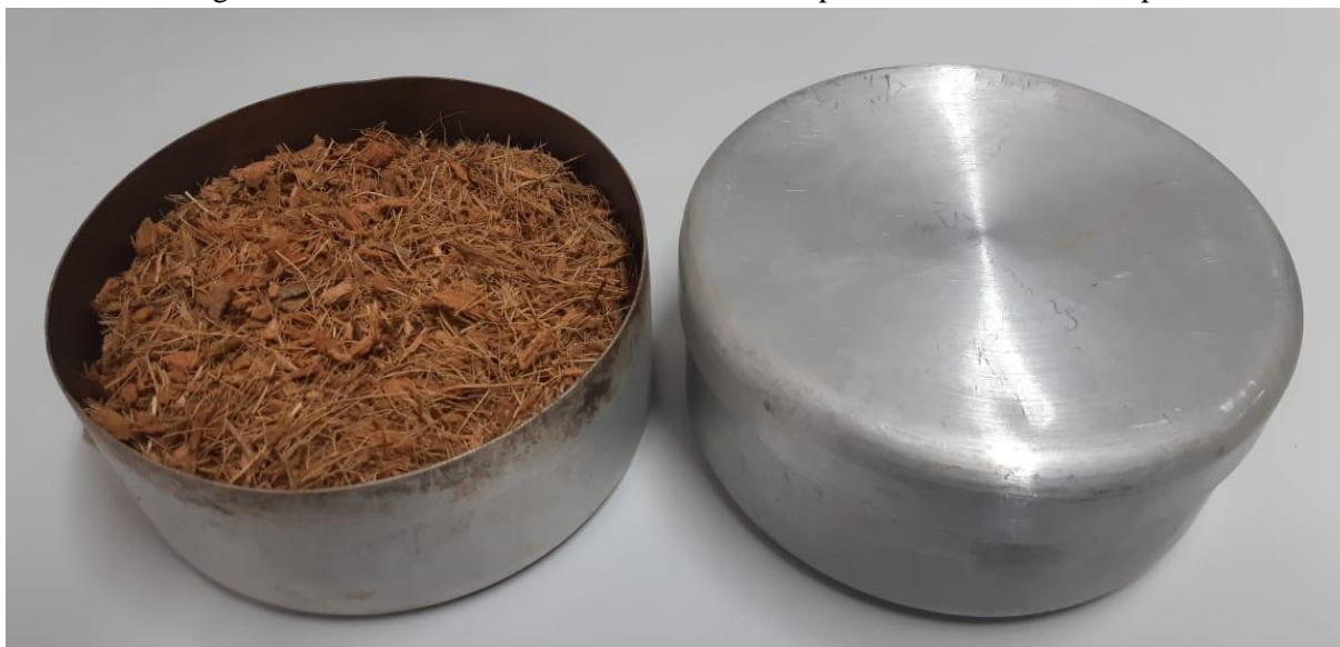
Figura 12 - Fibra triturada e armazenada em recipiente metálico com tampa
