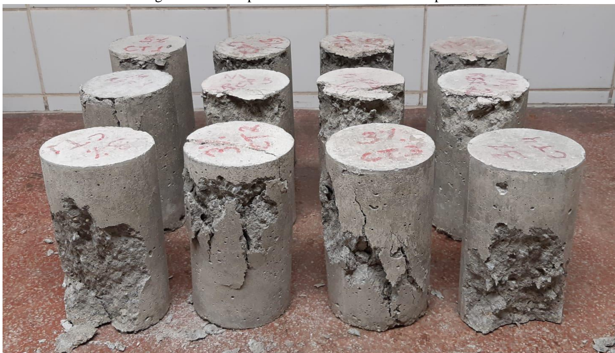
Figura 29 - CPs após ensaio de resistência à compressão
