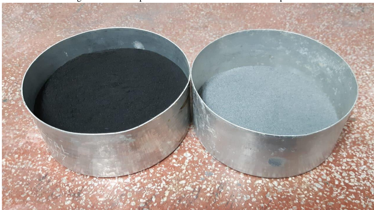
Figura 19 - Cinzas produzidas com e sem controle de temperatura
