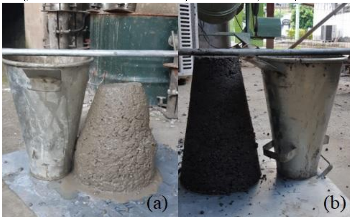
Figura 26(a) - Abatimento tronco de cone traço de referência
