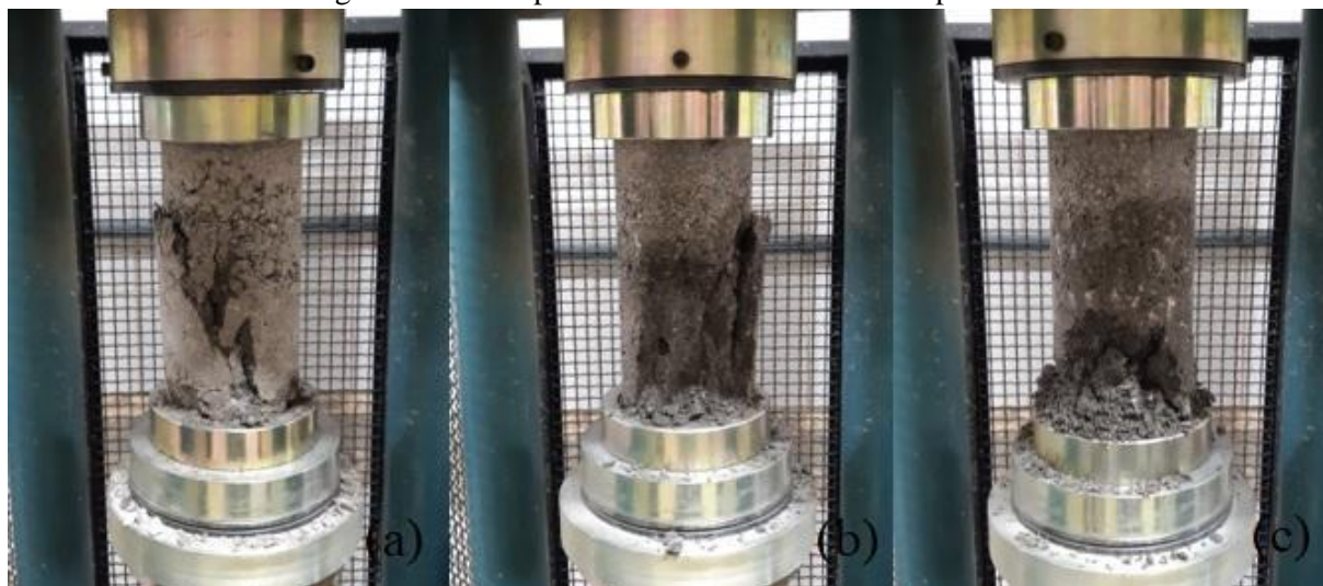
Figura 31(a) - CP com substituição de 3% de cimento por CFC-LAB
