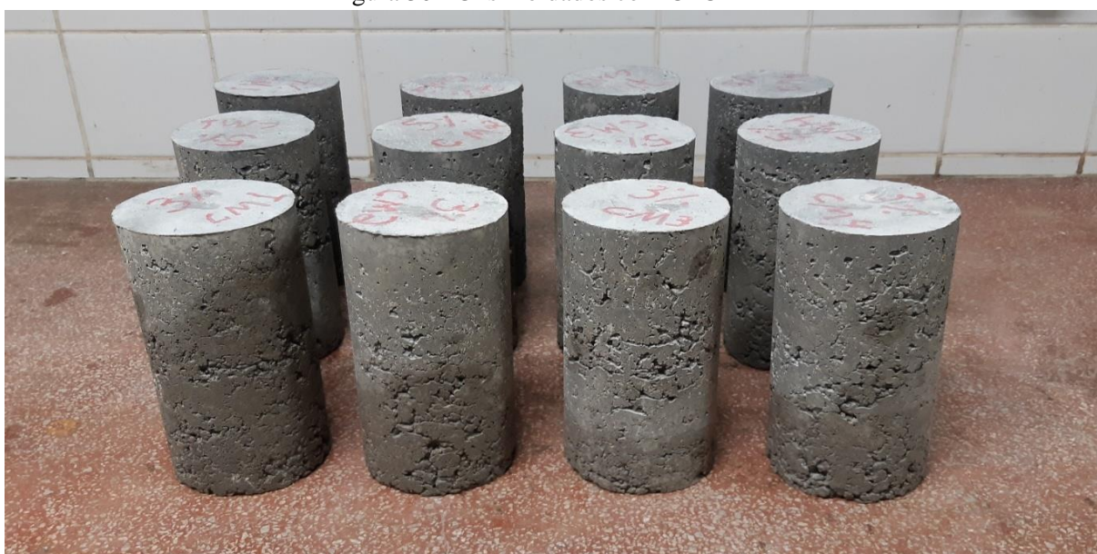
Figura 30 - CPs moldados com CFC-LAB
