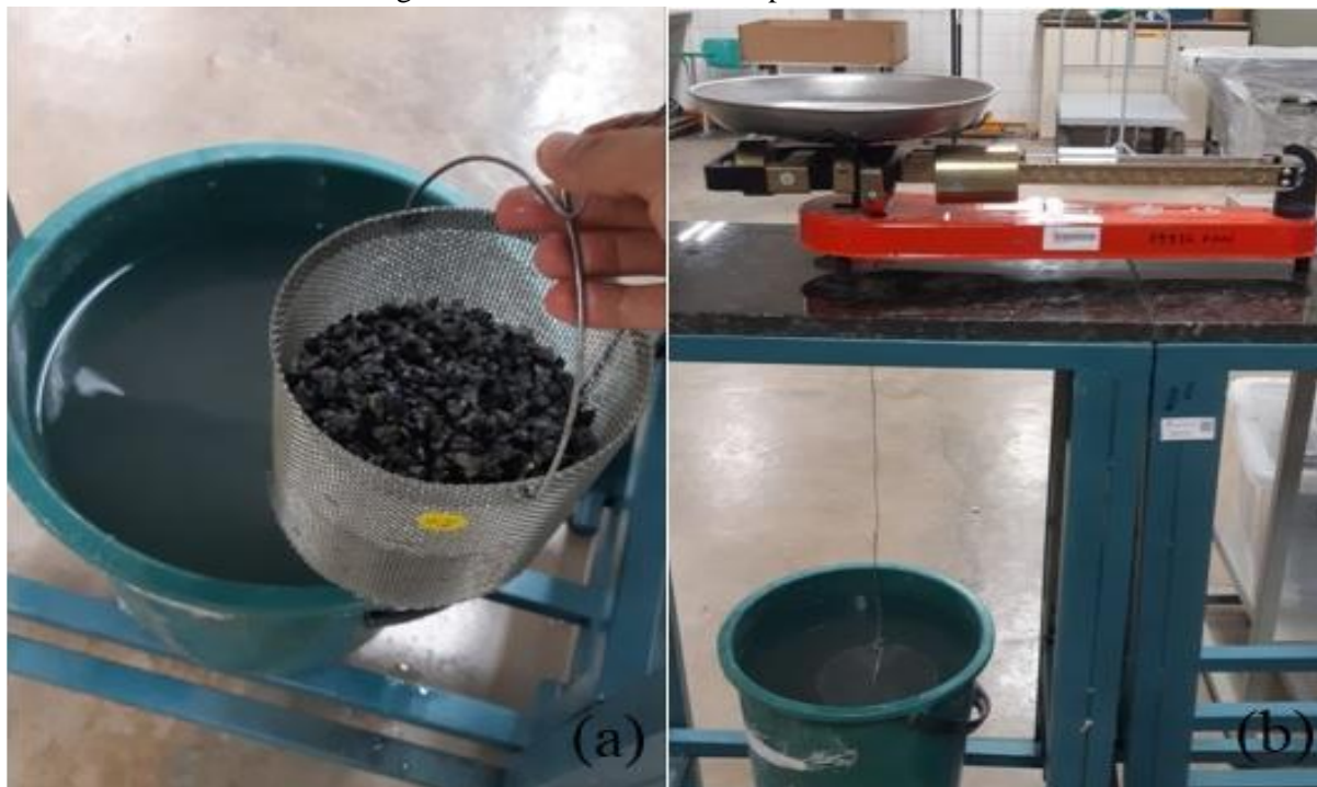
Figura 16(a) - Material submerso por 24h Fonte: Elaborado pelo autor.
