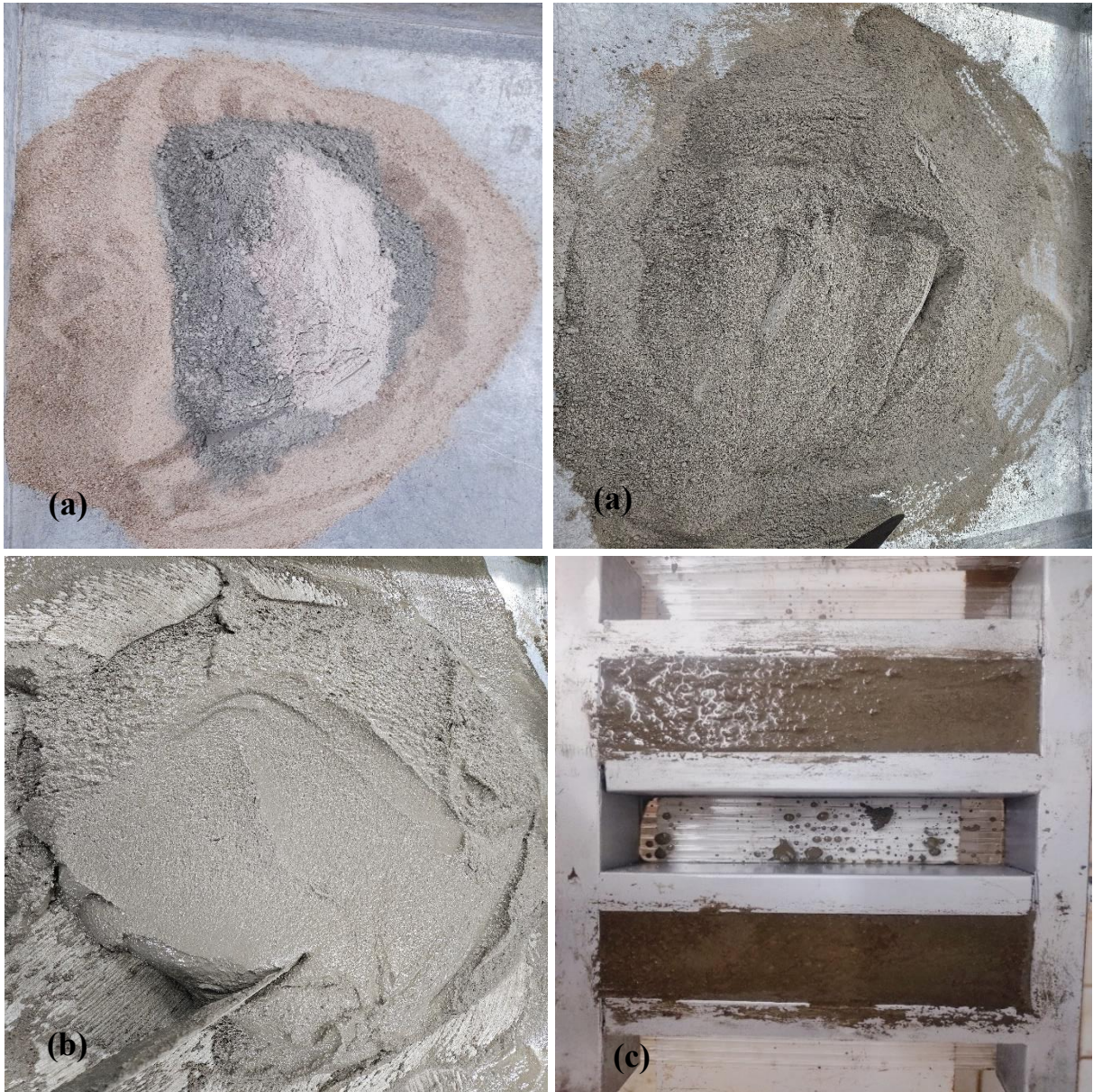
Figura 13- (a) homogeneização das matérias-primas secas, (b) após adição da água, (c) moldagem dos corpos de prova prismáticos, (d) corpos de prova desmoldados e (e) cura úmida
