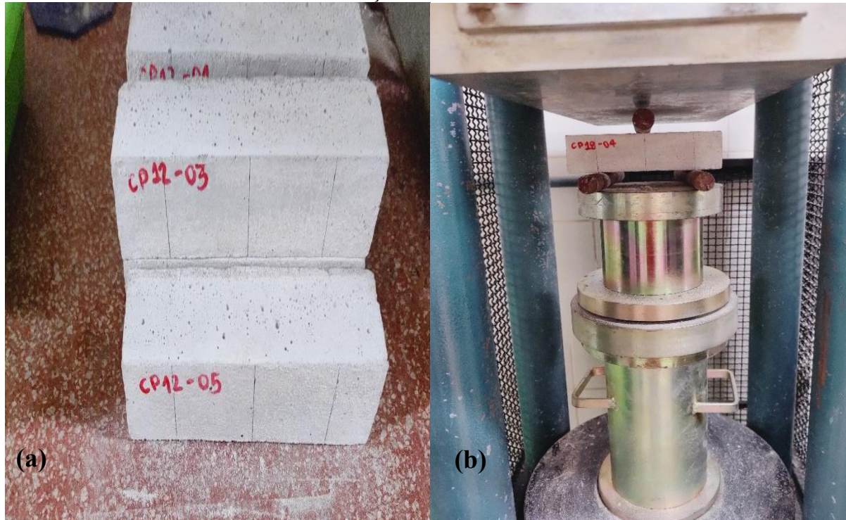
Figura 16 - (a) Marcações nos corpos de prova e (b) Execução do ensaio de resistência à tração na flexão
