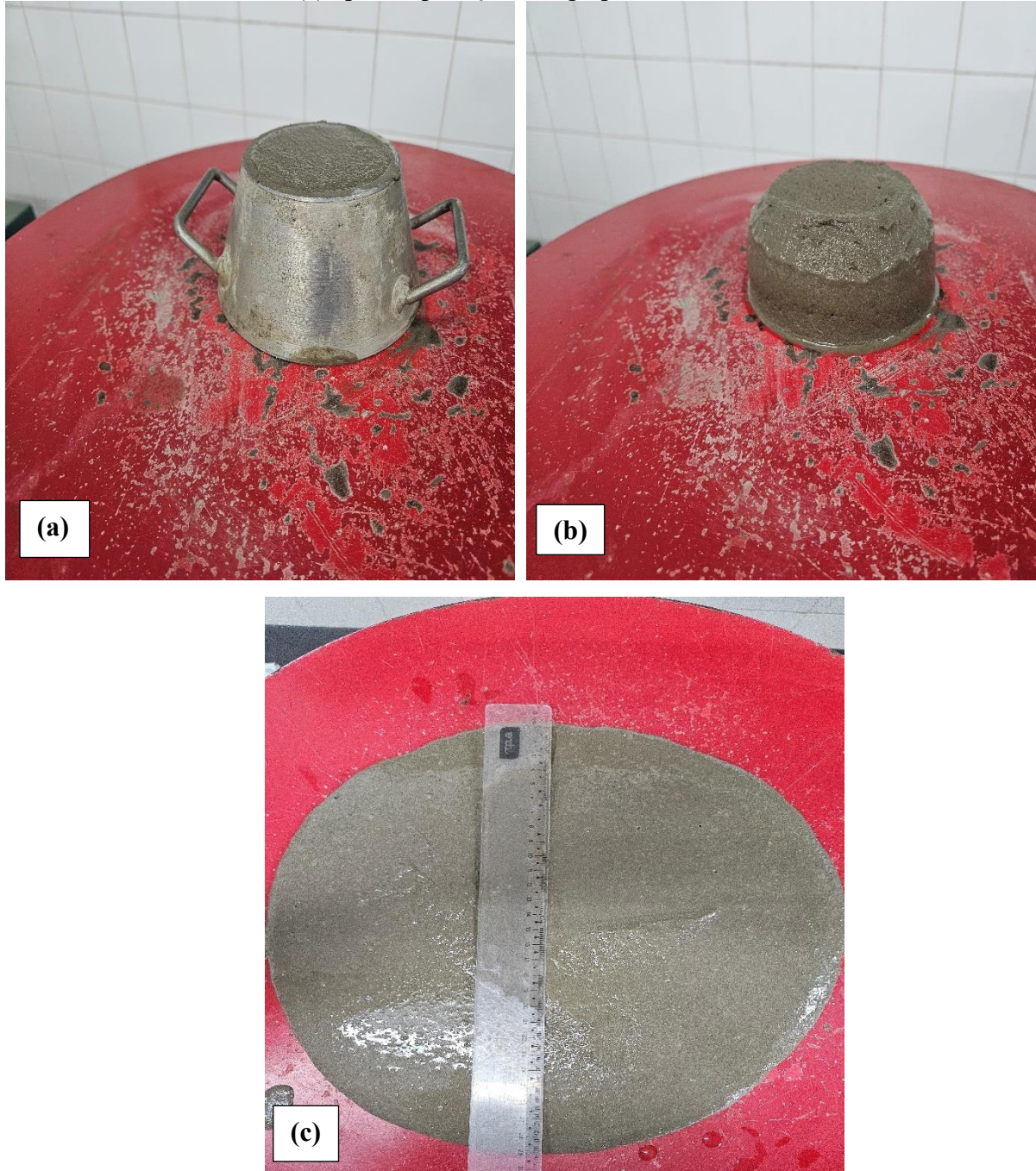
Figura 18-(a) molde metálico preenchido com a argamassa, (b) após a remoção do molde tronco cônico e (c) após a aplicação dos golpes na mesa de consistência
