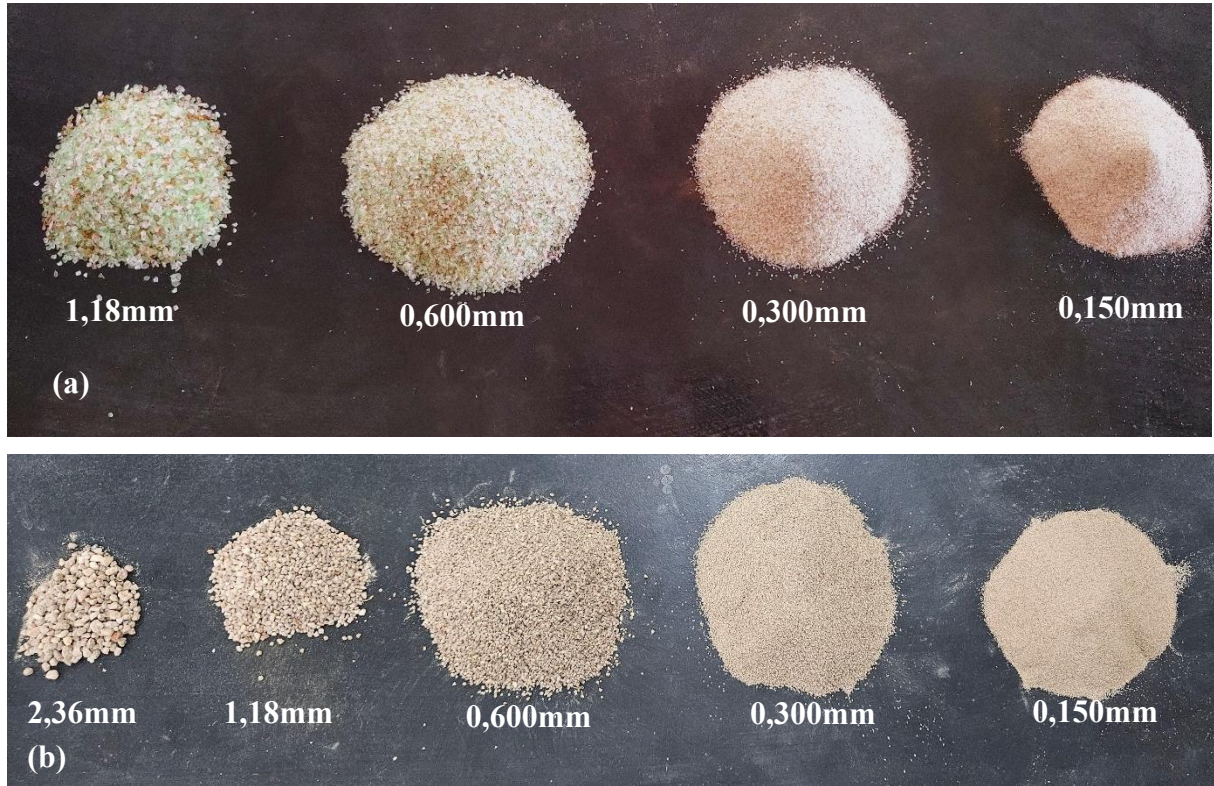
Figura 11-Massa retida nas peneiras da série normal (a) para subproduto e (b) para o agregado miúdo
