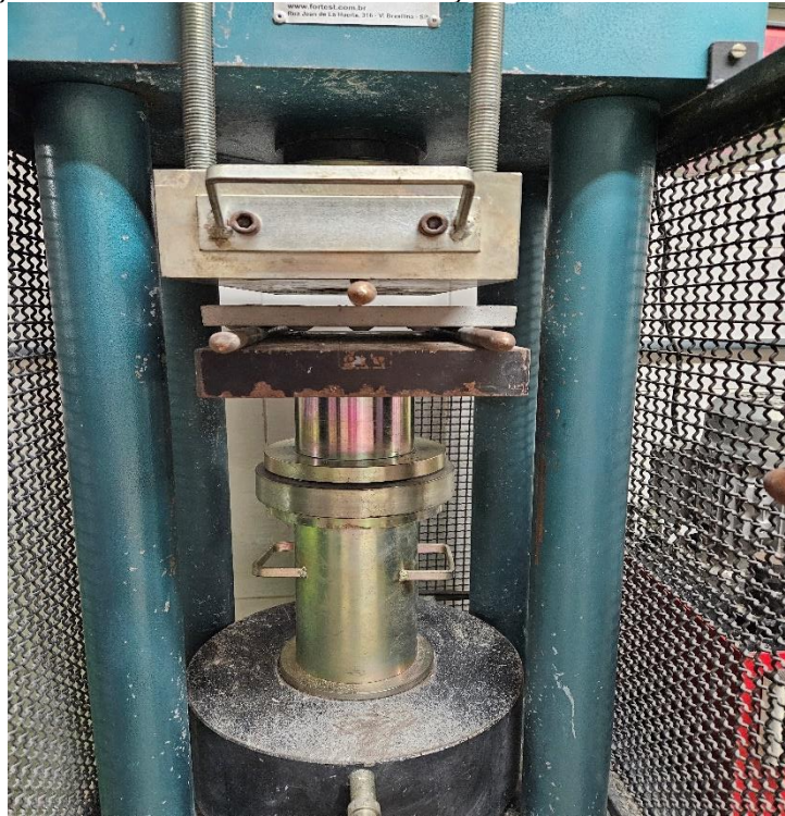
Figura 19- Execução do ensaio de resistência à tração na flexão no ladrilho hidráulico
