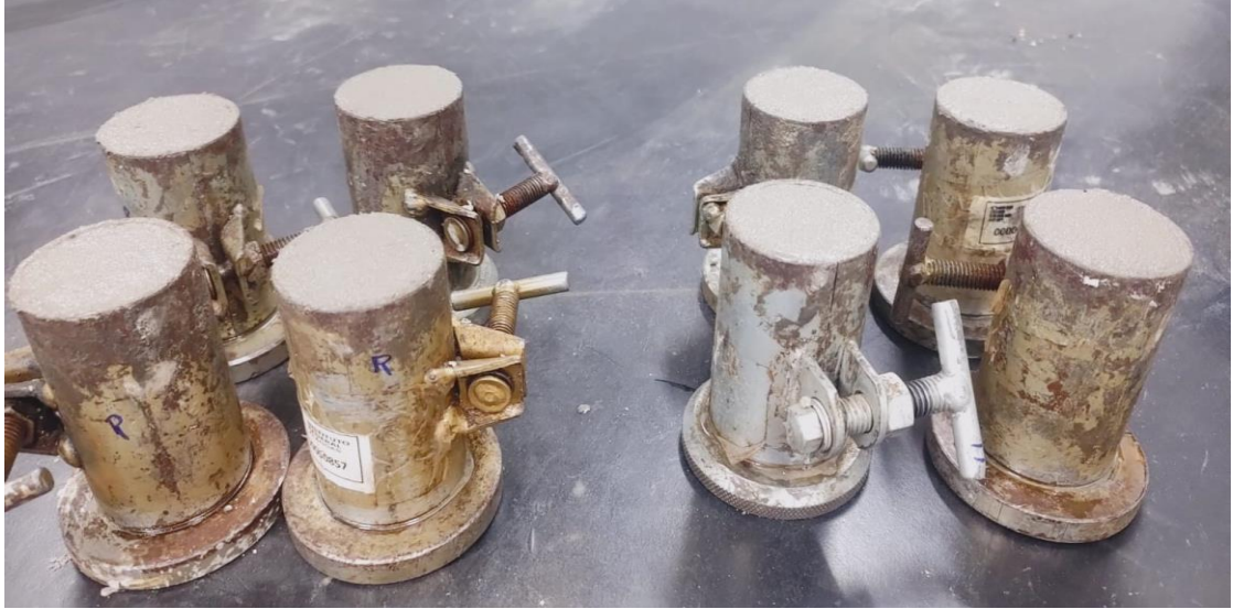
Figura 12-Corpos de prova cilíndricos para execução do ensaio de índice de desempenho com cimento Portland aos 28 dias
