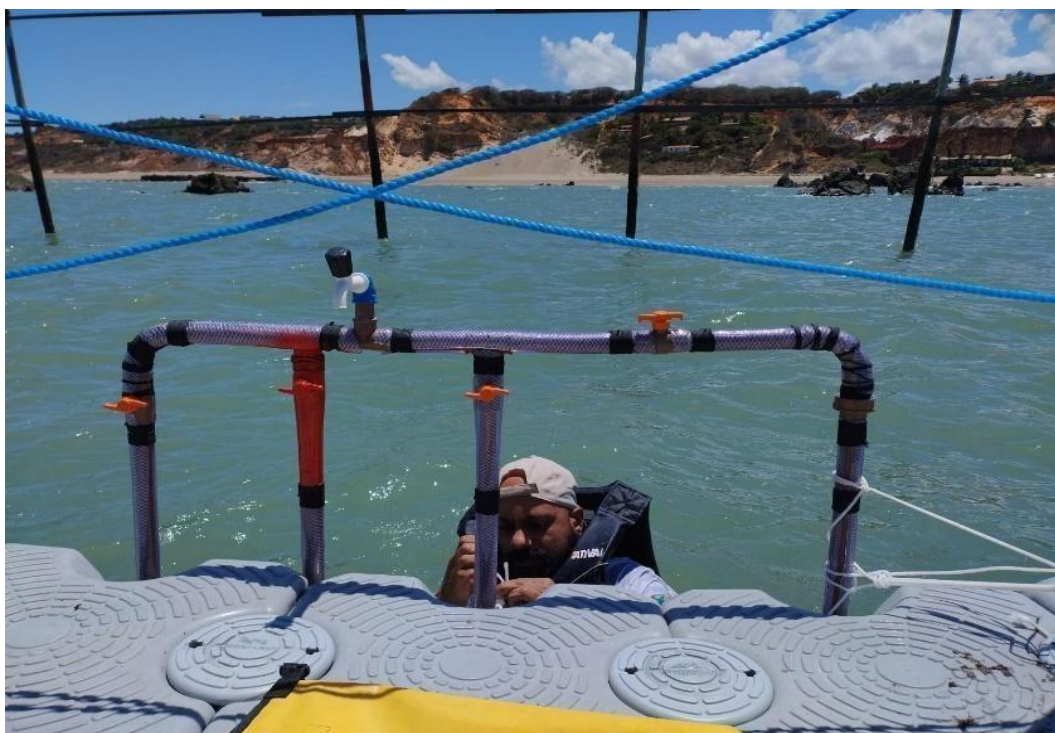
Figura 26. Imagem do sistema e encanamento dos olhos d'água fixado na plataforma flutuante
