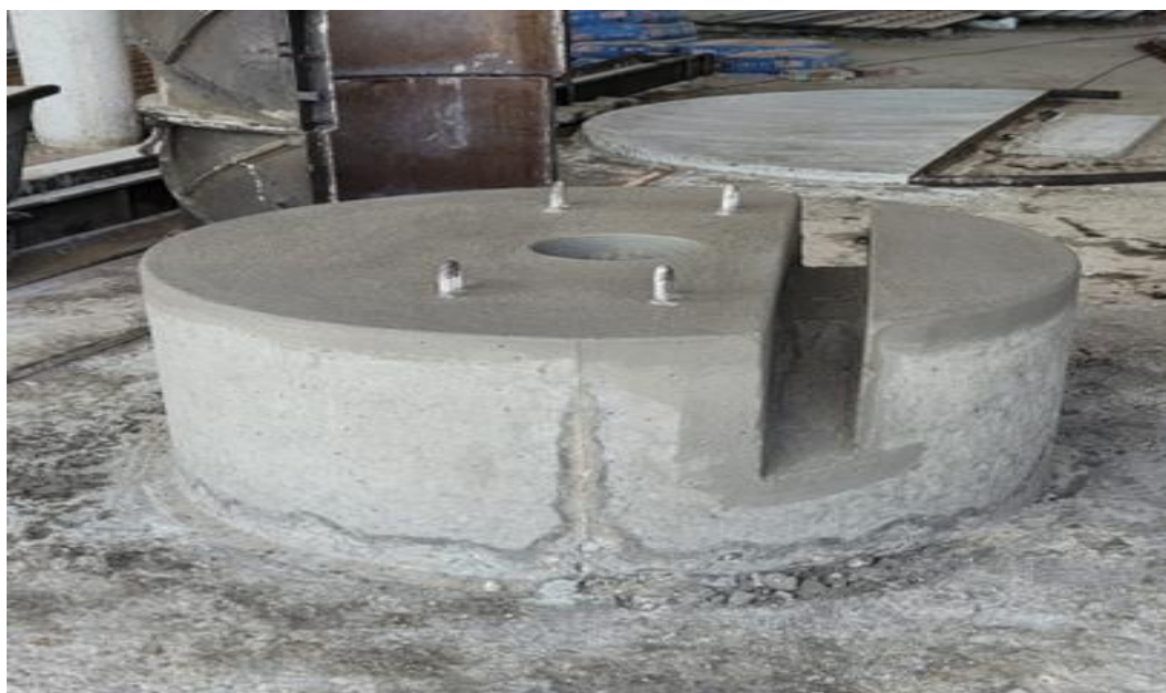
Figura 17. Poitas de concreto projetada para fixar toras de eucaliptos e rede do Cerco
