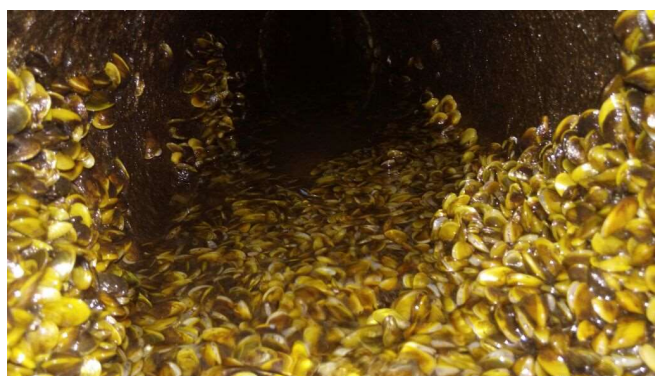
Figura 1: Macro incrustações por mexilhão-dourado nas paredes do tubo por câmera endoscópica.
