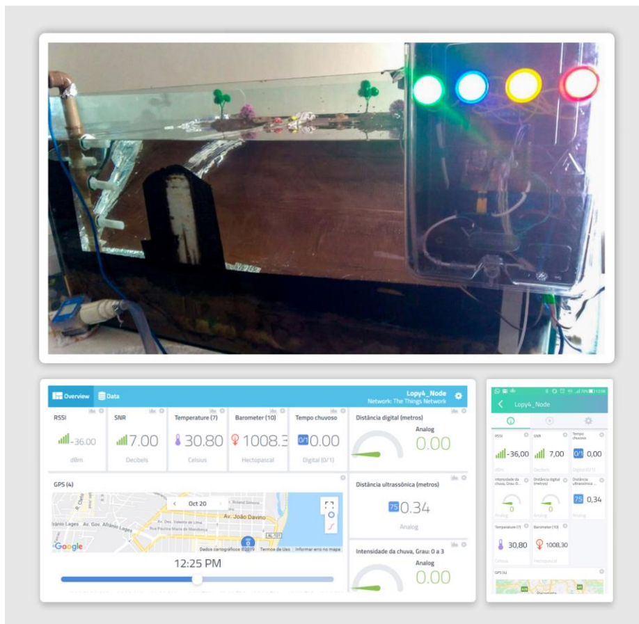
Figura 7. Ambiente laboratório com sensores acoplados, cenário inundação, com os respectivos dashboards web e mobile.
