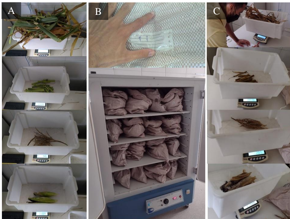
Figura 6 – Determinação da massa verde de folhas, colmo, pendão e espiga (A), material em estufa de circulação forçada de ar a 65 °C (B) e determinação da massa seca de folhas, colmo, pendão e espiga (C)
